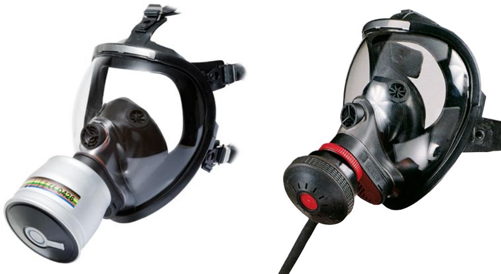
Maschera panoramica di taglia universale, di concezione innovativa, conforme alla *Norma Europea EN 136*. Per l'impiego con filtri antipolvere, antigas e combinati dotati di raccordo filettato EN 148/1 e, nelle versioni SP/A per sovrappressione, con apparecchi di alimentazione d'aria respirabile (con raccordo EN 148/3). Disponibile in **EPDM** e in **silicone**.
